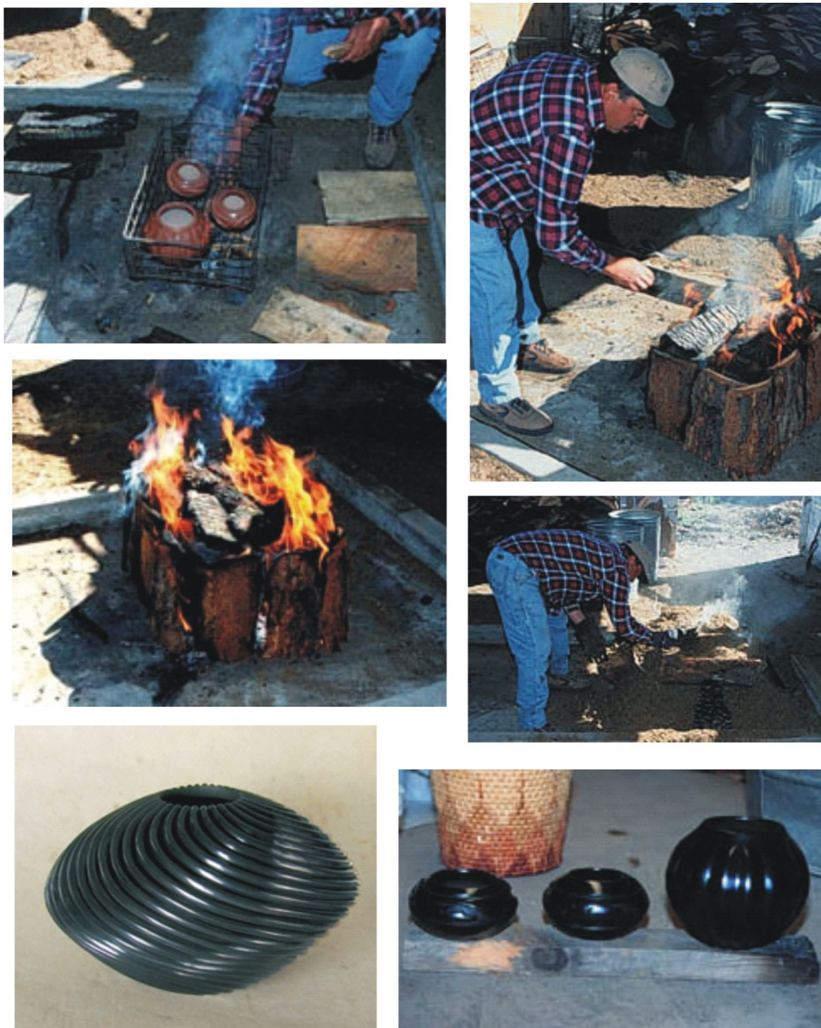
Fig. 78. Arderea în aer liber, Pueblo (sus). Vase arse în atmosferă reducătoare (jos) (după ROLLER 1999; YOUNGBLOOD 2004).
