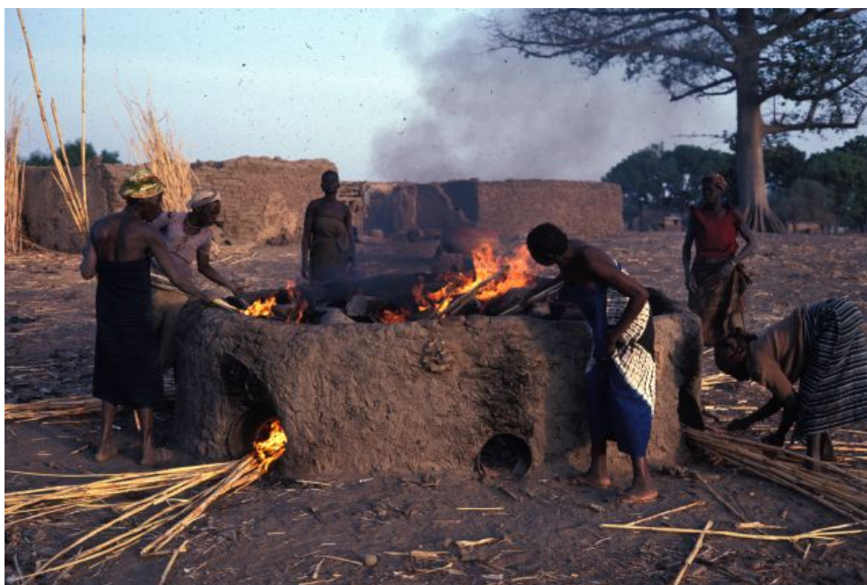
Fig. 88. Cuptor cu o singură cameră, cu vatra neorganizată, Nigeria (după ONOKPITE 2015).
